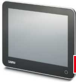
Полностью закрытый IPC с классом защиты IP65 и дисплеем 38,1 см (15")
