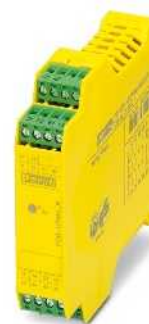
Модуль расширения с широкодиапазонным входом (42-230 В)
