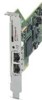
Маршрутизатор с межсетевым экраном и VPN для PCIe
