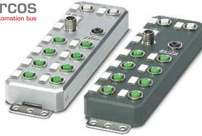
8 дискретных входов и 4 дискретных выхода
