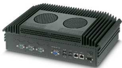
Высокопроизводительный блочный ПК для настенного монтажа
