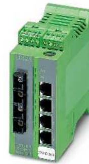
4 порта RJ45 и 2 оптических порта (одномодовые)
