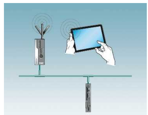
Visu+ mobile на мобильном конечном устройстве посредством точки доступа, с промышленным ПК и веб-сервером в качестве опции
