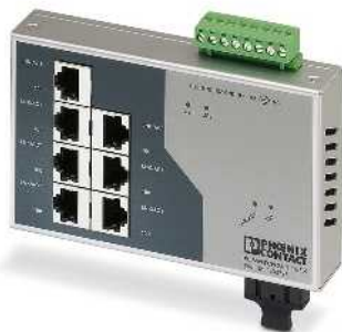
7 / 15 портов RJ45 и 1 оптический порт
