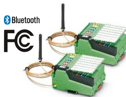
Комплект для беспроводного доступа, с антеннами
