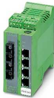
4 порта RJ45 и 2 оптических порта (многомодовые)
